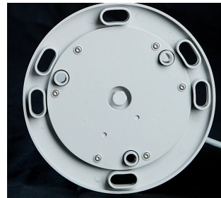
Instalación La placa base de la SC 110 se puede instalar en una estructura usando 3 o 4 pernos M12 en un diámetro de 200 mm o 3 pernos M8 en un diámetro de 150 mm.
